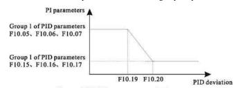
Figure 6-30 PID parameters switchover
